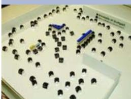
Mesoskopische Systeme (1 cm bis 10 cm) Schwarm „Microroboter“ der Testplattform Jasmin des Instituts für Verteilte Systeme der Universität Stuttgart.
