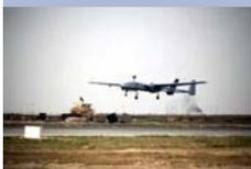
Metaskopische Systeme (1m und größer) MALE<sup>5</sup> - Unbemanntes Fluggerät (UAV) Heron 1 zur taktischen Luftaufklärung mit langer Stehzeit im Operationsgebiet
