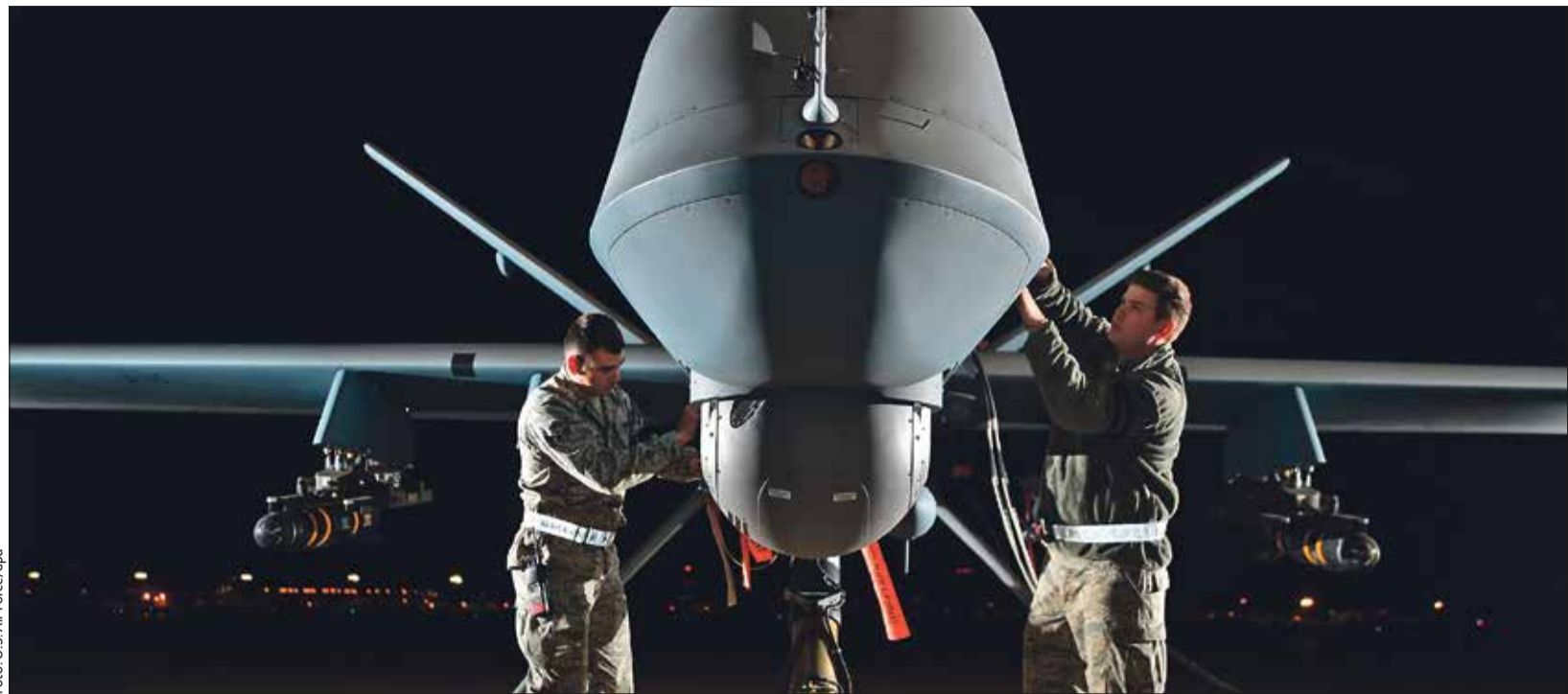
➤ Kampfflugzeug ohne Piloten: Soldaten der US Airforce bereiten eine Kampfdrohne vom Typ MQ-9 Reaper für den Start vor.
